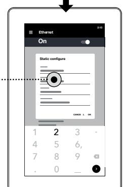
Vyplňte IP adresu tabletu, masku, bránu, DNS server a uložte nastavení. Pro odchod ze servisního menu klepněte na tlačítko „odejít“ v pravém horním rohu aplikace.
